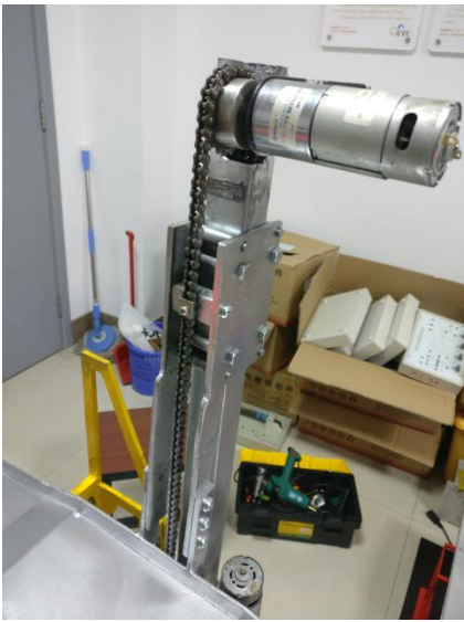
图 (6) 提升系统结构实物图
